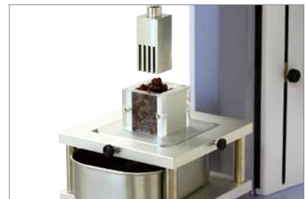
⑰ Mini Kramer shear cell / Ottawa cell ⑩ Jig platform
