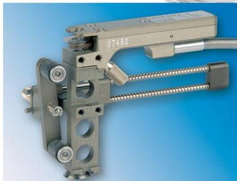
**MF** ist ein deutscher Hersteller von Extensometern für statische Tests. Anklemm-Extensometer wie das im Bild links gezeigte Mini-MFA2 eignen sich für hochpräzise E-Modul-Messungen. Im Gegensatz dazu sind Ärmchen-Extensometer sehr universell und über lange Messwege verwendbar.
