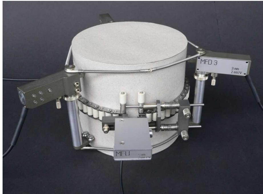
Bild 1: Längenänderungsmesssystem MFD 3 mit MFU 4 für Umfangsmessung Kleinste Messlänge des MFD 3 in Kombination mit MFU 4 = 60 mm
