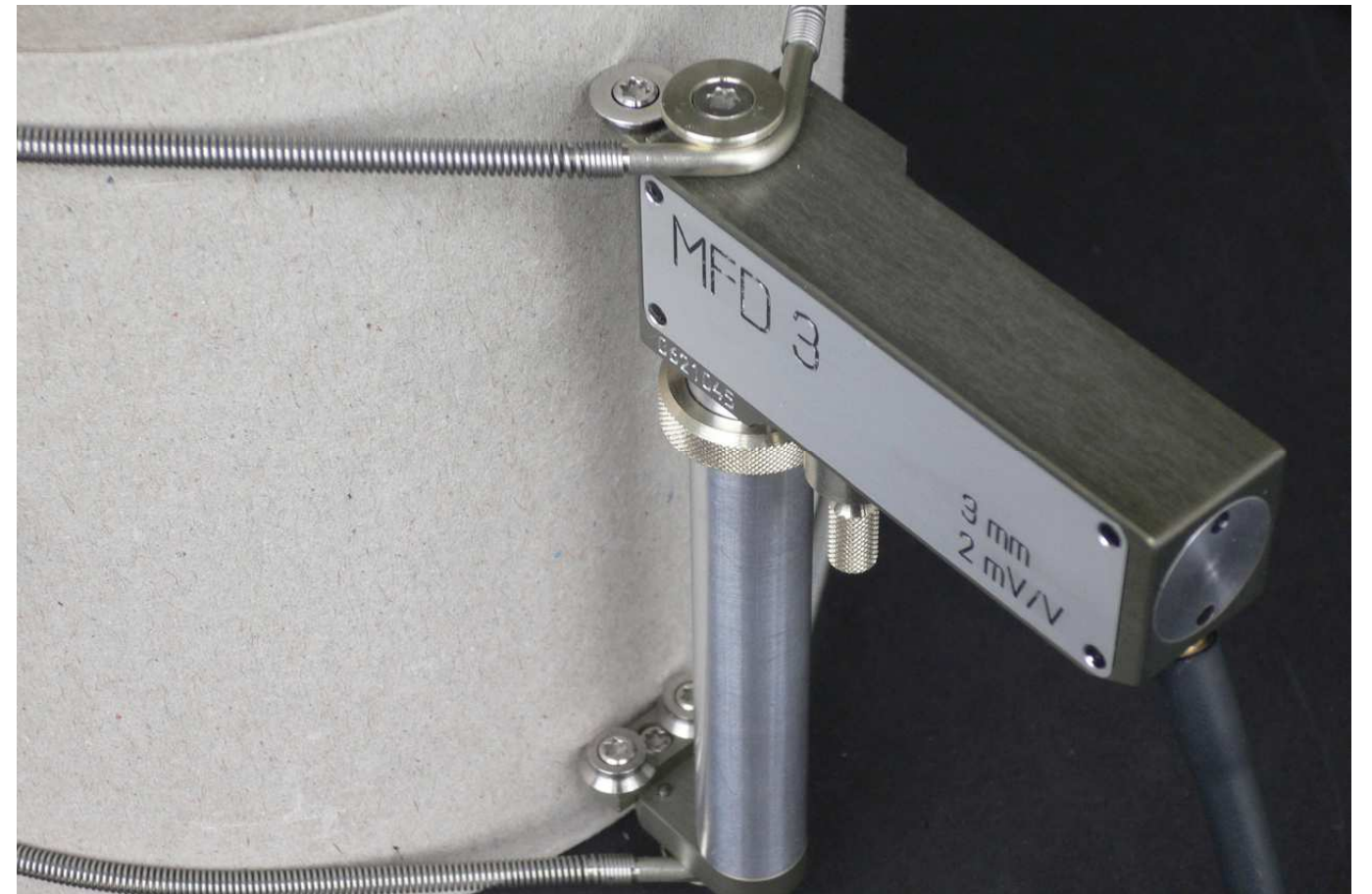
Bild 2: Sitz der Winkelstücke am Messwertaufnehmer
